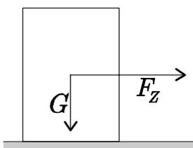
Bedňa sa začína po dlážke auta šmýkať až od istého jeho zrýchlenia  $a$ . To je dané tým, či trecia sila pôsobiaca proti takémuto jej pohybu prevýši veľkosť zotrvačnej sily. Ak  $F_Z \geq F_T = mg\mu$ , bedňa sa začne šmýkať. Úpravou dostaneme  $a \geq g\mu$ . Ak je toto  $a$  menšie než ohraničenie zistené pri skúmaní prevracania bedne, tá sa skôr začne šmýkať než prevracať. Teda dostávame pre neprevracajúcu sa bedňu nerovnosť
