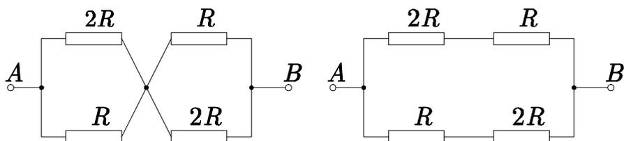
Ak chceme cestu prúdu čo najviac sťažiť, volíme odpor  $R_X$  čo najväčší. Takýmto je zapojenie, keď medzi uzly siete nezapojíme vôbec nič, odpor bude nekonečný (pozri obrázok). Teraz ide o jednoduchú paralelnú kombináciu dvoch odporov s hodnotou  $(R + 2R) = 3R$ , teda  $R_{\max} = 3R / 2$ .
