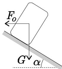
Zátačkou prejdeme bez úhony iba ak trecia sila  $F_T$  daná prítlačnou silou telesa k podložke ( $F_T \leq \mu F_N$ ) stačí kompenzovať silu  $F_X$ . Dosadením a úpravou dostaneme
