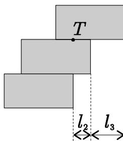
Keďže ťažisko horných dvoch tehál leží „v strede“, odtiaľ  $l_2 = l/4$ . Ťažisko troch tehál určíme z rovnosti momentov tiažových síl:  $mg(l/2 - l_3) = 2mgl_3$ . Odtiaľ  $l_3 = l/6$ . A teda celkový presah je rovný  $l_1 + l_2 + l_3 = 11/12l$ .
