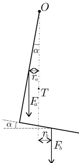
Môžeme si teda vypočítať polohu ťažiska a z toho uhol odklonu, alebo si hneď napíšeme podmienku rovnosti momentov (momenty, ktoré spôsobujú jednotlivé ramená, počítame vzhľadom na bod  $O$ )
