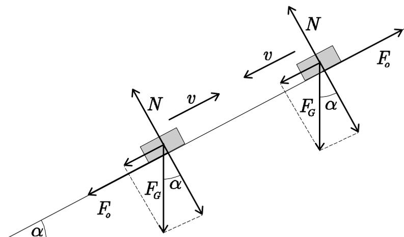
Keďže sa teleso pohybuje len v smere naklonenej roviny má normálová sila práve veľkosť kosínusovej zložky gravitačnej sily (pre odporovú silu preto platí  $F_o = \mu N = \mu F_G \cos \alpha$ ): Teda pri pohybe nahor pôsobí na teleso sila
