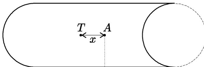
potom jeho ťažisko bude v bode  $A$ . Teda inými slovami momenty gravitačných síl pôvodného útvaru a doplneného kruhu sú vzhľadom na bod  $A$  rovnaké. Plocha pôvodného útvaru je  $ab$ , plocha doplneného kruhu je  $\pi(b/2)^2$ , potom pre momenty síl platí
