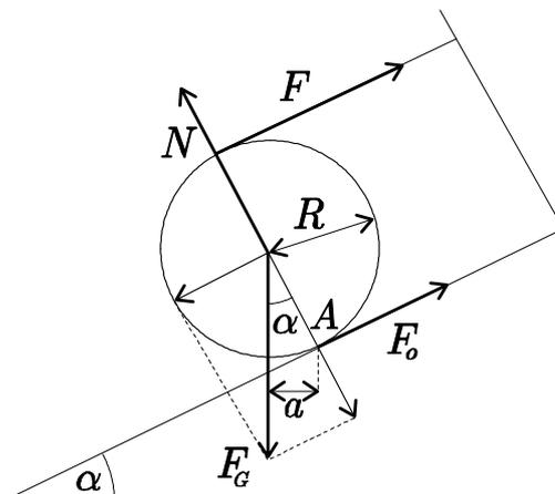
Na valec pôsobia dohromady štyri sily: gravitačná sila  $F_G$ , trecia sila  $F_o = N\mu$ , normálová sila  $N$  a sila ťahu lana  $F$ . Momenty síl budeme počítat' vzhľadom na bod  $A$ , aby nám hneď vypadli normálová a trecia sila, ktorých moment je vzhľadom na tento bod nulový:
