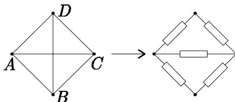
Môžeme teda spojenie  $BD$  z obvodu odstrániť. Ostane nám jednoduchá paralelná kombinácia odporov  $2R$ ,  $R$  a  $2R$  tak ako na druhom obrázku. Jej odpor už určíme ľahko
