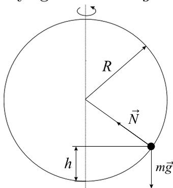
Ak uhol odklonu od zvislice je  $\alpha$ , potom polomer otáčania guľičky je  $\rho = R \sin \alpha$ . Newtonovu rovnicu  $\vec{N} + m\vec{g} = m\vec{a}$  môžeme zapísať v prepise na zvislú a vodorovnú os:
