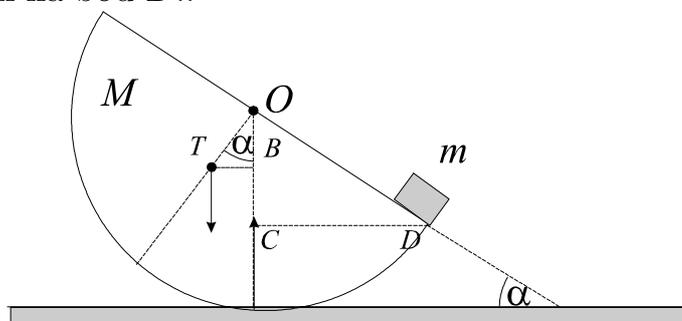
Gravitačná sila  $Mg$  má rameno  $TB + CD$ , sila podložky  $N = Mg + mg$  má rameno  $CD$ . Z geometrie obrázka vyplýva  $TB = OT \sin \alpha = 3/8r \sin \alpha$ ,  $CD = r \cos \alpha$ , takže po dosadení má momentová veta tvar
