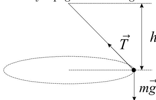
Ak uhol odklonu je  $\alpha$ , potom Newtonova rovnica  $\vec{T} + m\vec{g} = m\vec{a}$  v prepise so zvislého a vodorovného smeru má tvar
