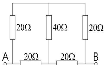
Jej symetria spôsobuje, že prostredným odporom veľkosti  $40\ \Omega$  nebude tiecť prúd. Z tohto dôvodu je možné jej odpor vypočítať ako obyčajnú paralelnú kombináciu dvoch odporov veľkosti  $40\ \Omega$  (táto veľkosť je daná zapojením dvoch odporov veľkosti  $20\ \Omega$  za sebou). Takto nakoniec dostávame výsledný odpor  $R_{AB}$  podľa vzťahu
