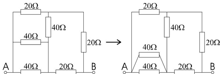
Výsledná hodnota paralelného zapojenia dvoch odporov veľkosti  $40\ \Omega$  je  $20\ \Omega$ . Nahradením spomínanej dvojice takýmto jedným odporom dostávame symetrickú schému.
